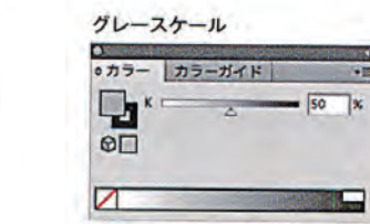
03-1 カラーをブラックの濃度の違いで表現するカラーモード。0(ホワイト)~100%(ブラック)の範囲で明度の値が指定される。主にモノクロ印刷などで使用される
