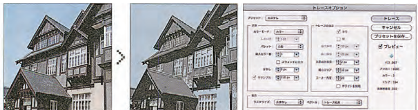
16 オブジェクトメニュー→「ライブトレース」→「トレースオプション...」でトレースする際の色数やパスの精度などを細かく設定できる。ここでは「カラーモード: カラー」で「最大カラー数: 3」に設定することで、カットアウト風の写真加工を行ってパスオブジェクト化している
