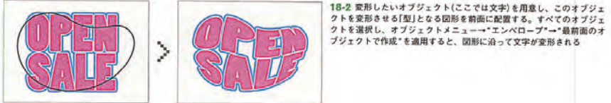
18-2 変形したいオブジェクト(ここでは文字)を用意し、このオブジェクトを変形させる「型」となる図形を前面に配置する。すべてのオブジェクトを選択し、オブジェクトメニュー→「エンベロープ」→「最前面のオブジェクトで作成」を適用すると、図形に沿って文字が変形される
